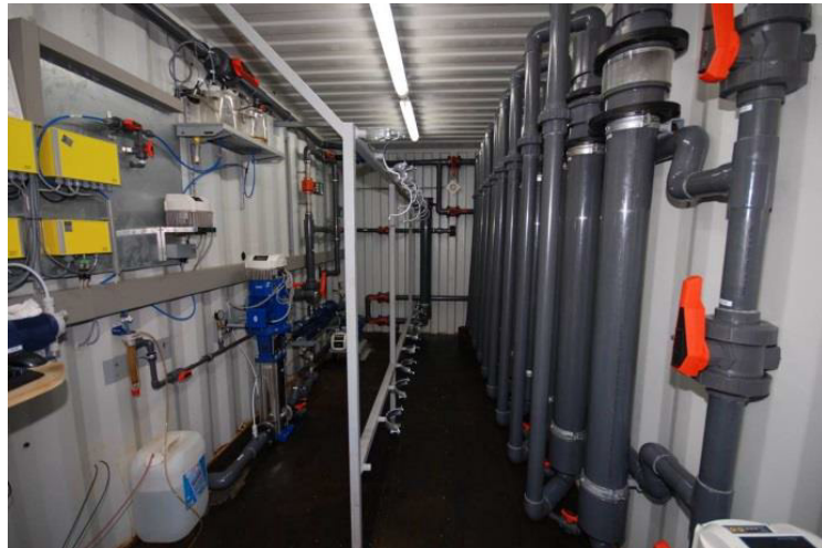
Abbildung: ferroDECONT-Verfahren in Pilotanlage mit Fließbettreaktoren
